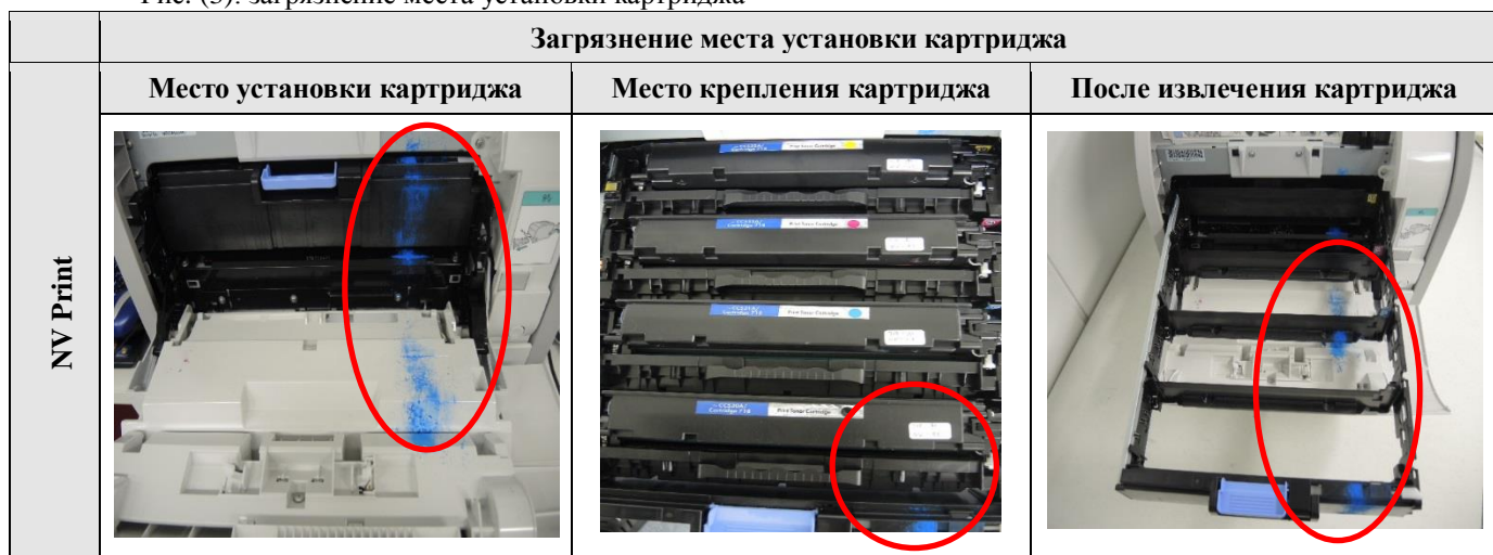
Рис. (3): загрязнение места установки картриджа
